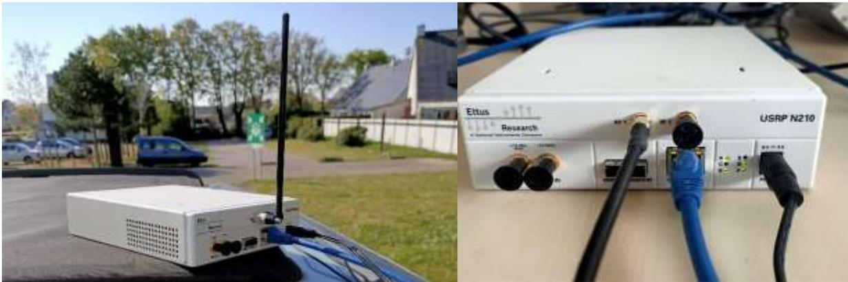
Figure 5 : émetteur Nb-CCSK outdoor et récepteur indoor
