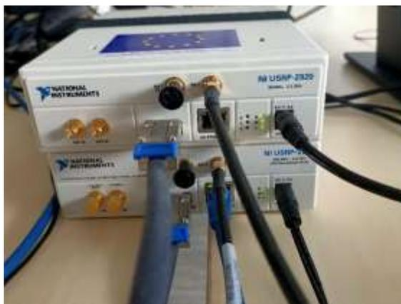
Figure 4 : émetteur et récepteur avec horloge MIMO
